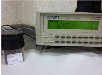
Fig. 3. Medições das propriedades térmicas numa amostra de ligante após 100 ciclos de temperatura.
