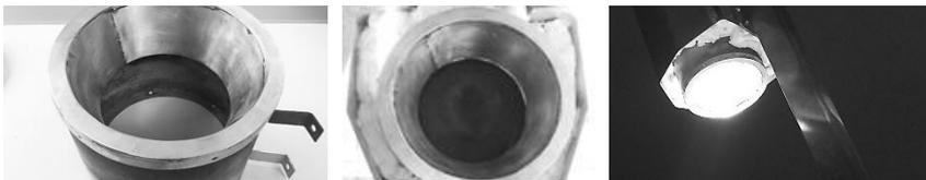
Fig. 8. Carcasa del absorbente con el reconcentrador cónico instalado.
