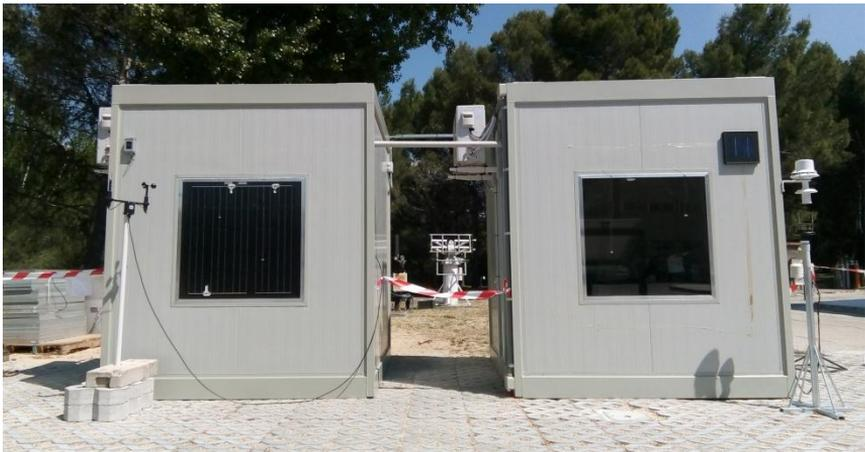
Fig. 1. Vista frontal de las dos casetas de ensayo, con las ventanas de los elementos a ensayar orientadas al sur. En la caseta de la izquierda hay un módulo FV semitransparente de silicio monocristalino y en la de la derecha un vidrio de iguales dimensiones.
