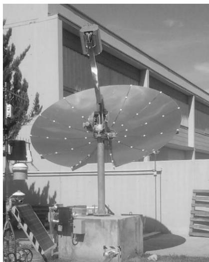
Fig. 1. Sistema de disco Stirling Trinum de 1 kWe instalado en Zaragoza.
