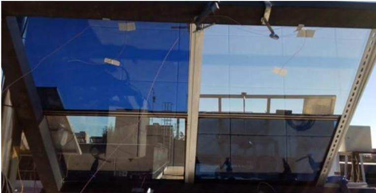
Fig. 1. Fotografía de las ventanas electrocrómicas en distintos niveles de oscurecimiento.
