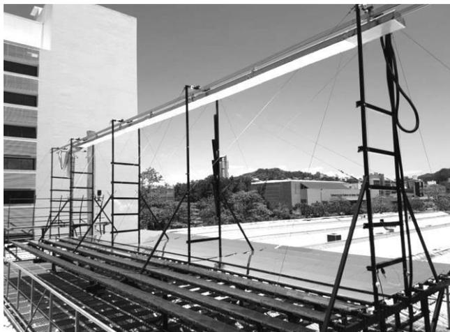
Fig. 1. Foto da Bancada do Concentrador Solar Fresnel Linear Instalada no LEPTEN/UFSC
