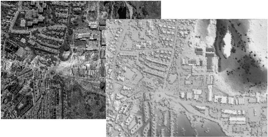
Fig. 2. Nube de puntos LIDAR del municipio de Alpedrete.
