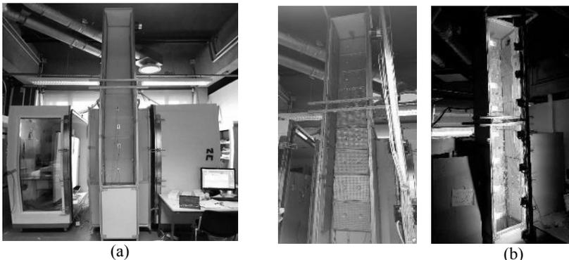
Fig. 1 – (a) Imagen del prototipo en vista frontal junto con la HGB e (b) imagen durante la fase de activación de la chimenea con paneles MCF
