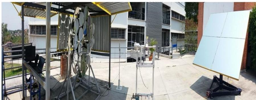
Figura 3: Horno Solar tipo Concentrador Anidólico.
