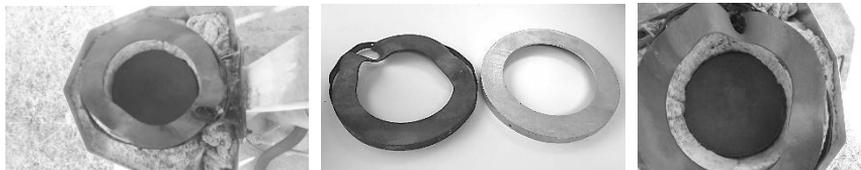
Fig. 4. Efectos el impacto de la mancha solar sobre la carcasa.
