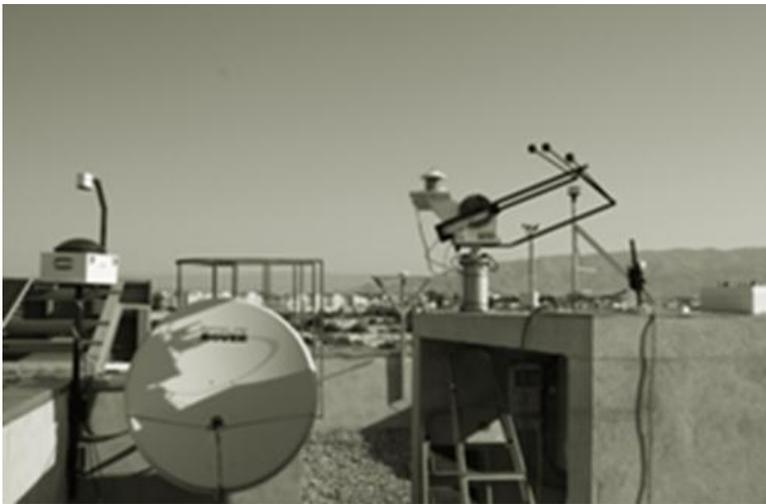
Fig. 1. Instalación experimental para predicción a corto plazo de la irradiancia solar en el centro CIESOL.
