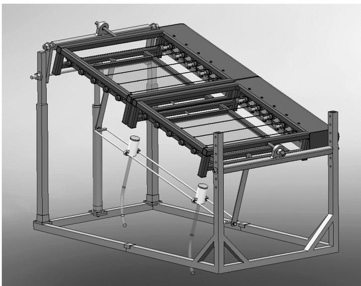
Fig. 5. Desenho de um protótipo (com 2 lentes de Fresnel e 2 cabos de fibra ótica) destinado a captar, concentrar, controlar e conduzir radiação solar.
