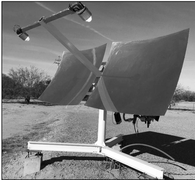
Fig. 1. Sistema Fotovoltaico de Alta Concentración con Óptica XRX-Kohler.
