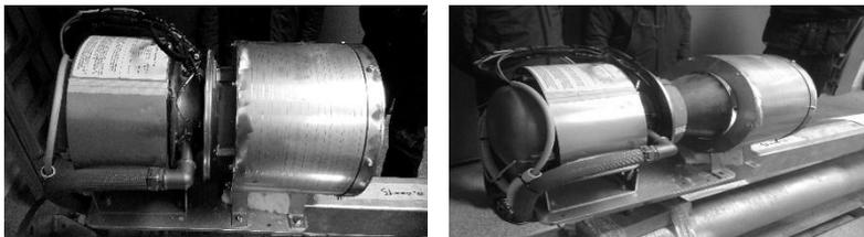
Fig. 2. Motor Stirling, absorbedor y cavidad.
